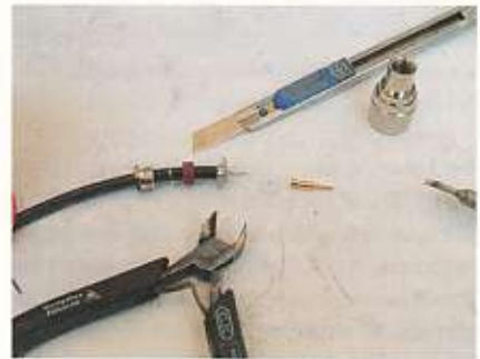
De N-connector voorbereid om gesoldeerd te worden.
